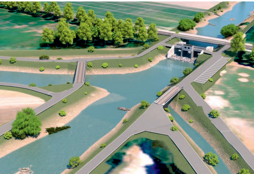
Modell im Massstab 1:40, Bereich Einmündung Rietaach in den Binnenkanal mit Sicht zum Drosselbauwerk
