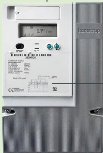
Elektro- und Wasserzähler Kamstrup 382M
